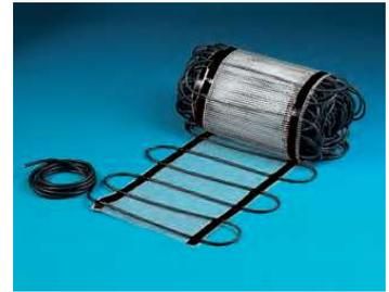
Das Heizsystem ist für die **Verlegung in Asphalt** nach DIN geeignet. Dieser wird in der Regel im 2-Schichtverfahren per Hand aufgebracht und verstrichen. Die Asphaltheizmatten werden auf der ersten erkalteten Asphaltenschicht ausgelegt und anschließend mit der zweiten Schicht (max. 30 mm) überzogen. Nach Erkalten dieser zweiten Schicht kann eine weitere Asphaltenschicht als Verschleißschicht aufgebracht werden (max. 30 mm).
