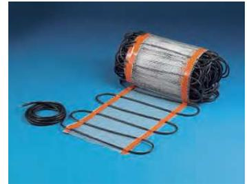
Das Heizsystem ist für die Verlegung im **Estrich, Magerbeton, Mörtel- oder Sandbett** (kein Splitt) geeignet. Durch die Vermattung auf ein formstabiles Trägernetz sind die Heizmatten besonders schnell zu montieren. Die verlegefertigen Heizmatten werden durch Einschneiden und Umklappen des Trägernetzes an die zu beheizende Fläche angepasst.
