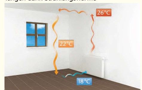
Thermik bei herkömmlichen Konvektionsheizsystemen
